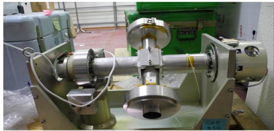
Maquette fonctionnelle du mécanisme d'orientation du miroir de Spot4
